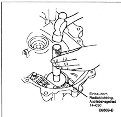
3. Ausgleichsgetriebe in Kupplungsgehäuse setzen.
