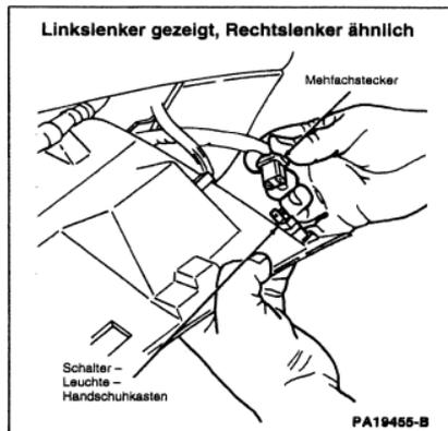
4. Zum Ausbau des Schalters der Leuchte – Handschuhkasten Haltenasen eindrücken und Schalter senkrecht abziehen.
