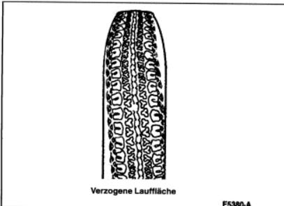
Bei verzogener Lauffläche schaukelt der Reifen bei niedriger Geschwindigkeit und verursacht Vibrationen ähnlich den Vibrationen eines Reifens mit statischer Unwucht bei hoher Geschwindigkeit. Reifen mit erheblich verzogenerem Profil sollten ersetzt werden.
